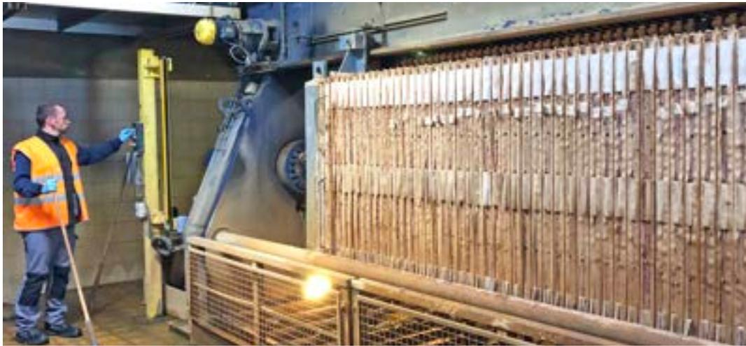
*Pour être transportées plus facilement, les boues sont déshydratées par filtres-presses (photo), par filtres-bandes, par centrifugeuse ou par séchage.*
